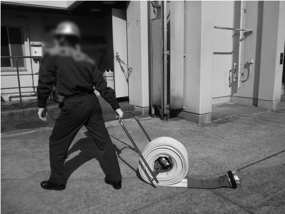
100ミリホース遠距離延長資機材使用でのホース延長時の隊員の姿勢
