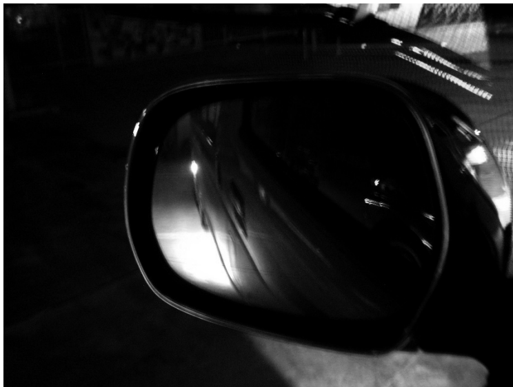
写真5 助手席側ミラーから見 たLEDテープ点灯時 の見え方
