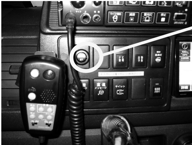
写真4 運転室スイッチ配置盤 に新設したLEDテー プのスイッチ
