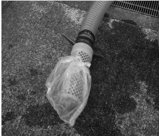
( 図 6 - 1 ) 沸騰泡を発生させるため、 ストレーナーに袋を被せた様子
