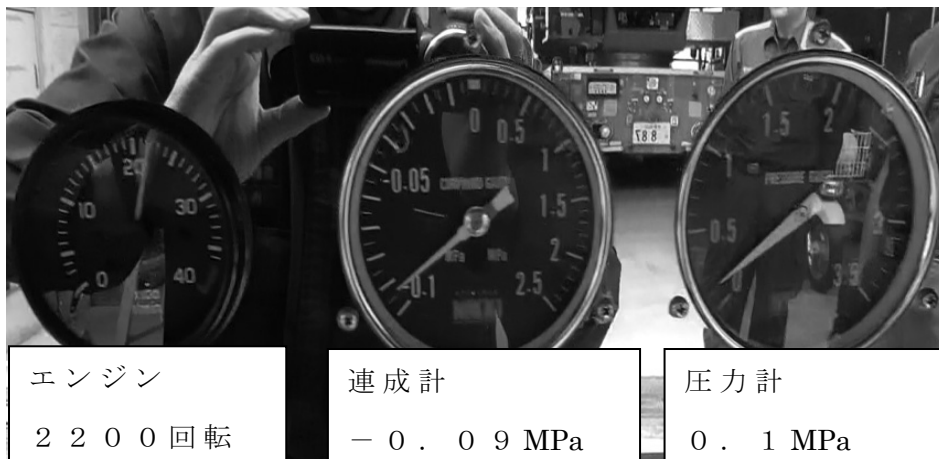
( 図 6 - 3 ) 沸騰泡発生時の計器類の指針。
