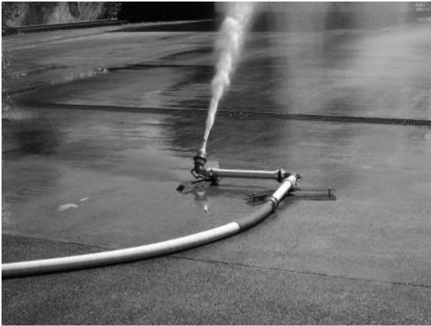
【図 11】放水銃として 2セット組み合わせて放水銃として使用可能
