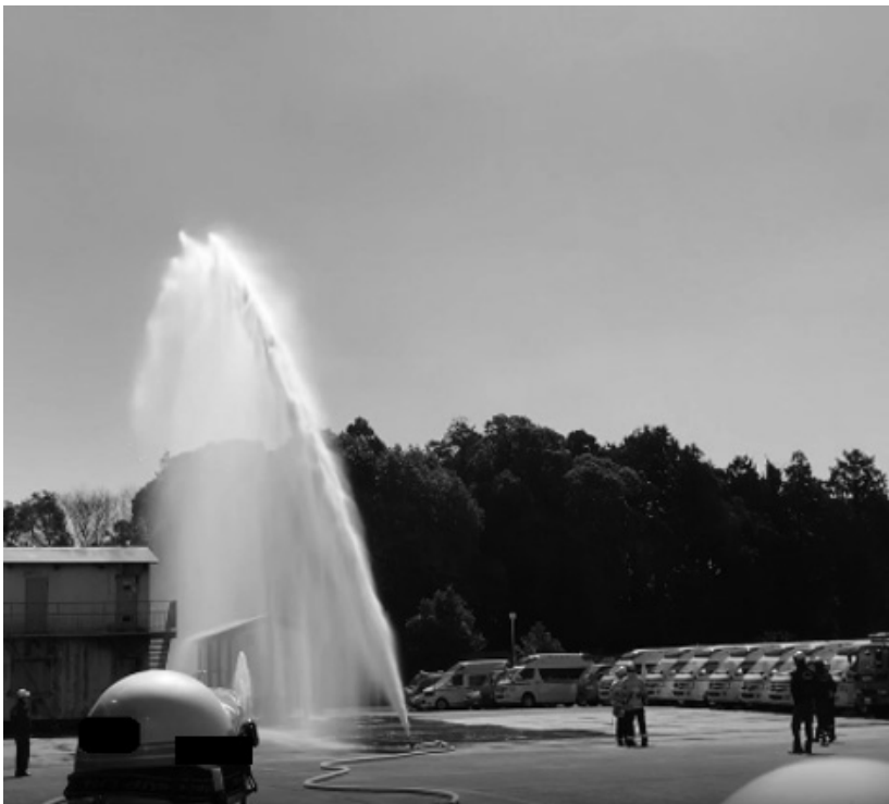
【図 12】放水銃としての能力テスト 放水量毎分 1,750ℓ超、飛距離は 50m 超
