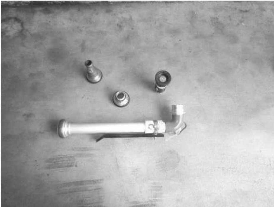
【図 7】 試作 6 号機の分解（ノズルは直・噴霧 2 セット） 試作 6 号機の脚部分の部品点数は、3 点となりました。
