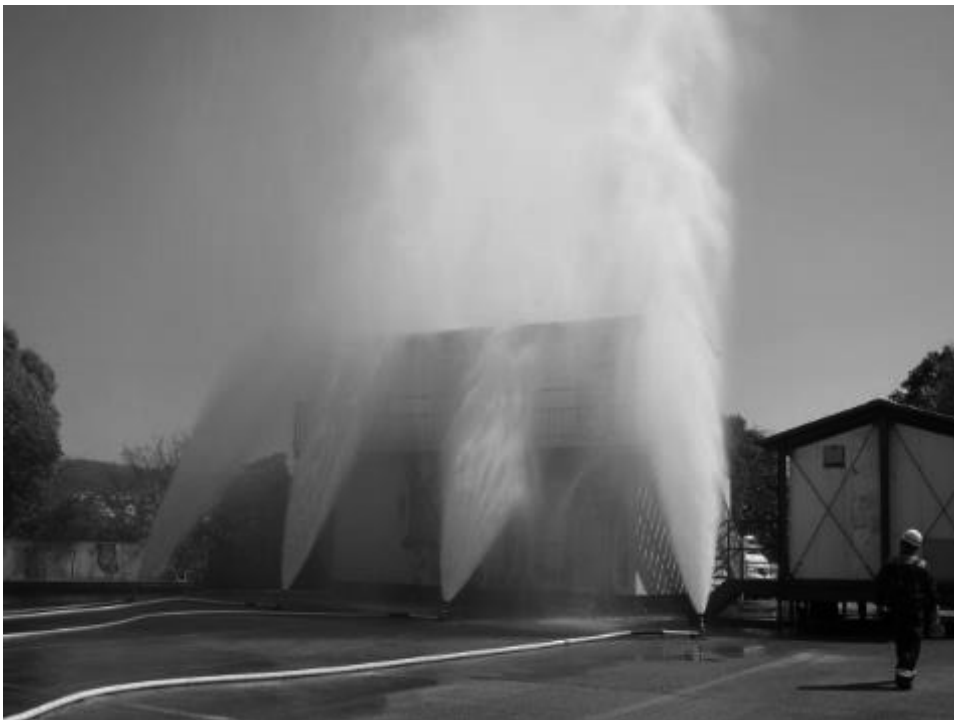
【図 10】放水テスト「風下飛び火防御」 風下延焼防止と飛び火迎撃のイメージ
