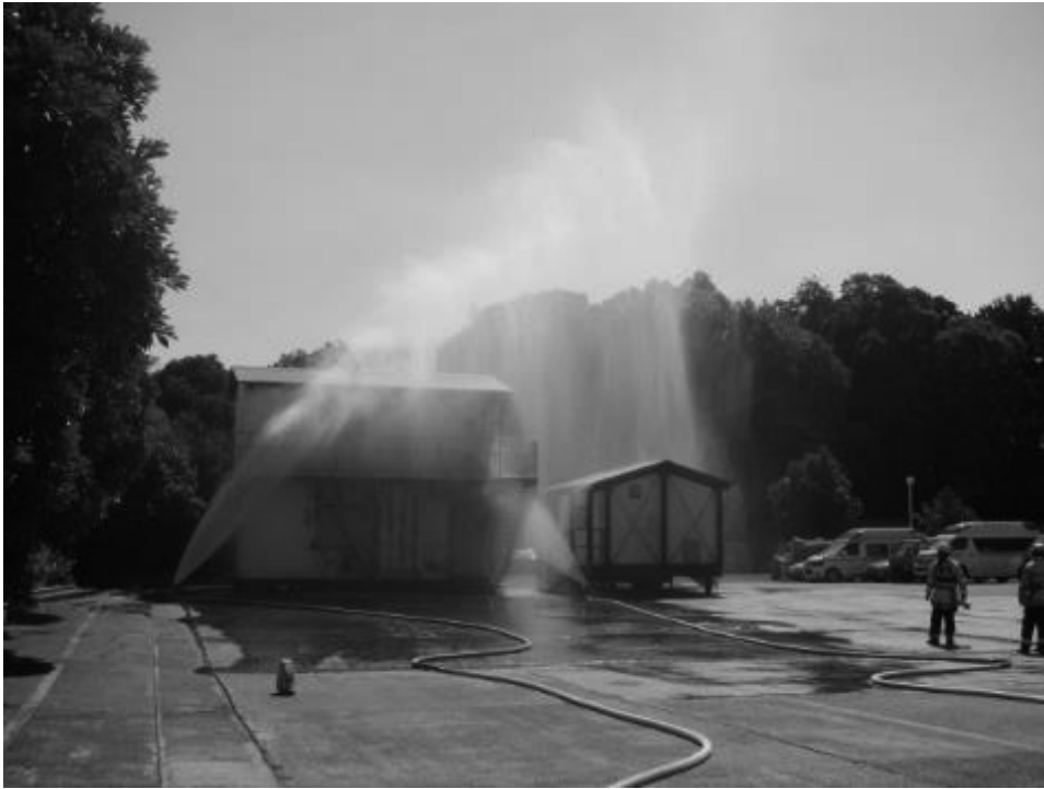
【図 9】放水テスト「延焼防止」 手前に隣接棟を想定して挟撃放水のテスト
