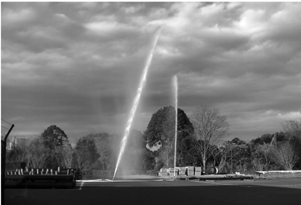
【図 8】 放水威力の比較 左は、本機器で毎分 1,000ℓ・右毎分 300ℓの放水
