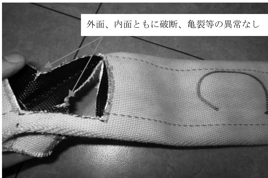
写真25 ホース切れ目の状態
