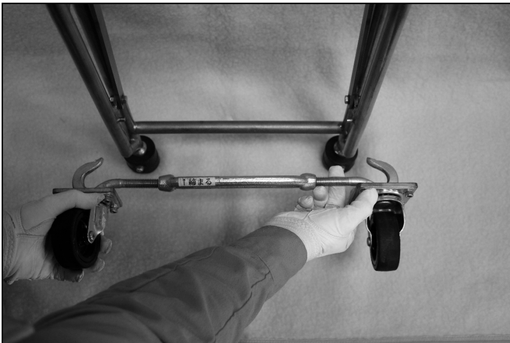
写真 7 取り付け方法（キャスターバックルを取り付ける器材の長さに調整）
