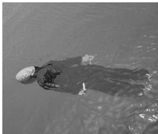
写真 8 海面浮遊状態 (水量 5 4 L 空気量 6 L)
