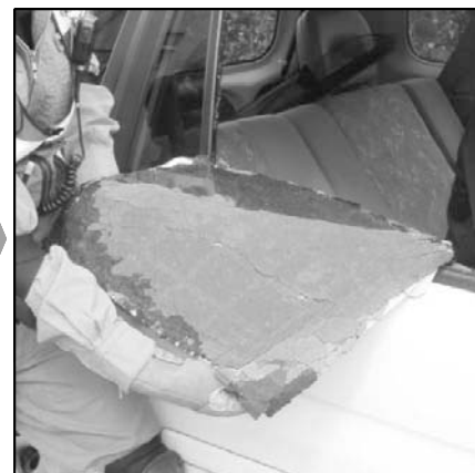
破壊したガラスは多目的安全シートに貼り付いている
