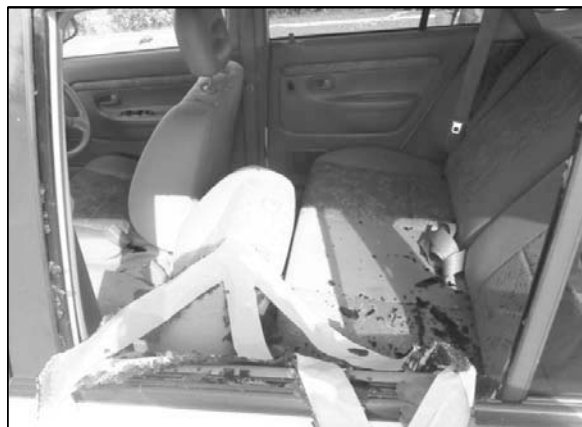
ガラス全体が落下し、テープの貼り付いていない部分は車内へ飛散する
