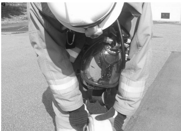
前傾姿勢をとると、圧力計に掛けた面体が前方に垂れ下がり、視認障害となる
