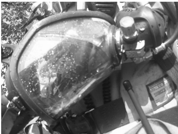
消火水等が面体表面に付着する
