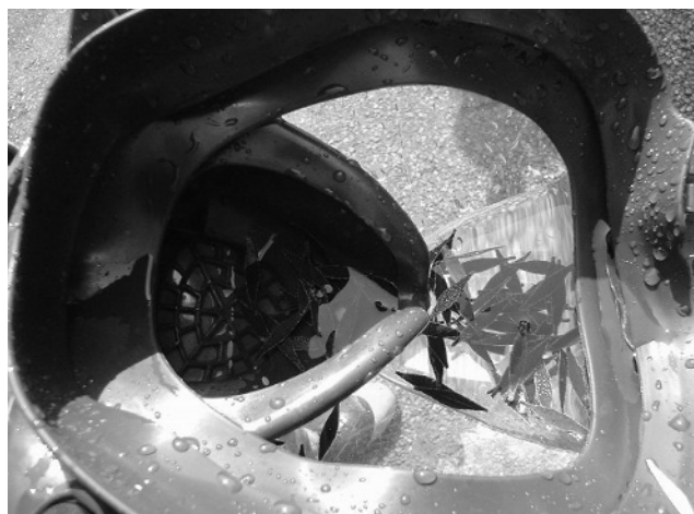
面体内部に、消火水、焼損物等が浸入し視認障害となるまた、これらを吸引してしまう危険性がある
