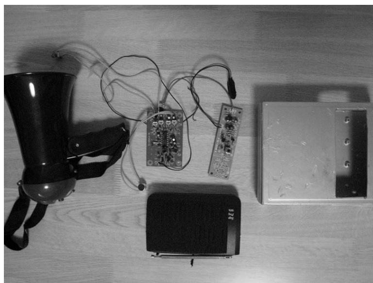
写真3 試作段階の自作トランスミッターによる音声システム
