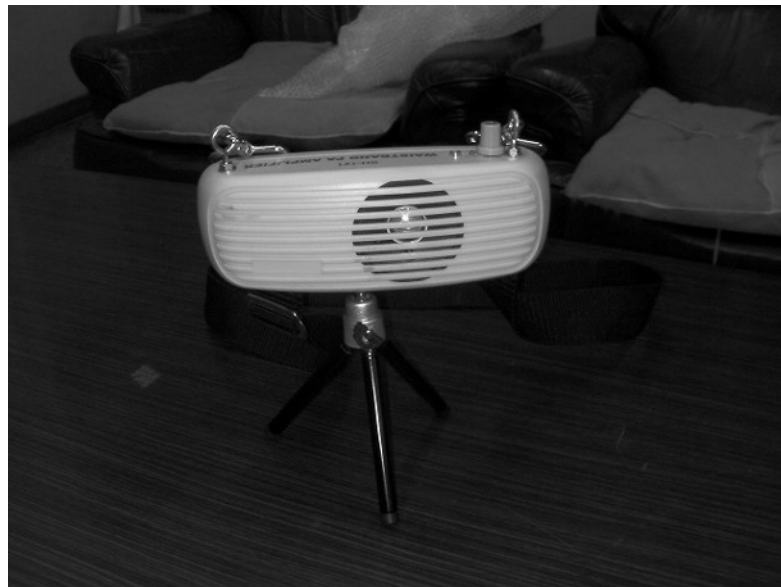
写真9 三脚付きのため作業に支障があれば固定拡声器として使用することもできる。
