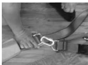
3. 肩掛けバンドD環部へ足部確保用バンドを接続する
