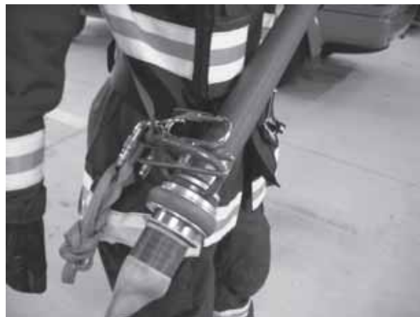
写真7 管そうの固定方法
