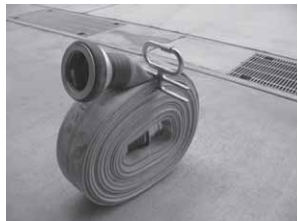
写真8 一重巻きホースの取り付け方法
