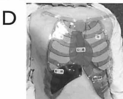
D 胸部の骨格の形に沿ってカット 厚さ0.5ミリメートル
