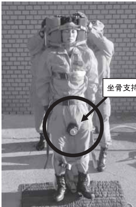
写真21 ロングボード 坐骨支持棒取付け正面
