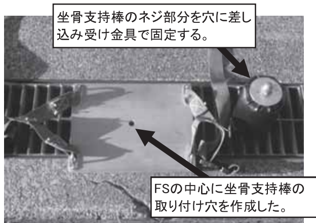
写真17 坐骨支持棒 取り付け穴
