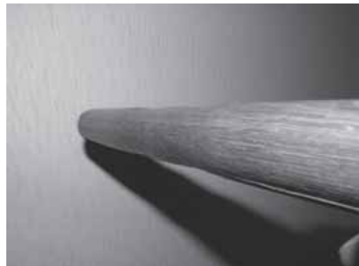
締め付けられるロープによって凹凸ができた木製トグル
