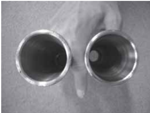
筒状に中をくり抜き軽量化
