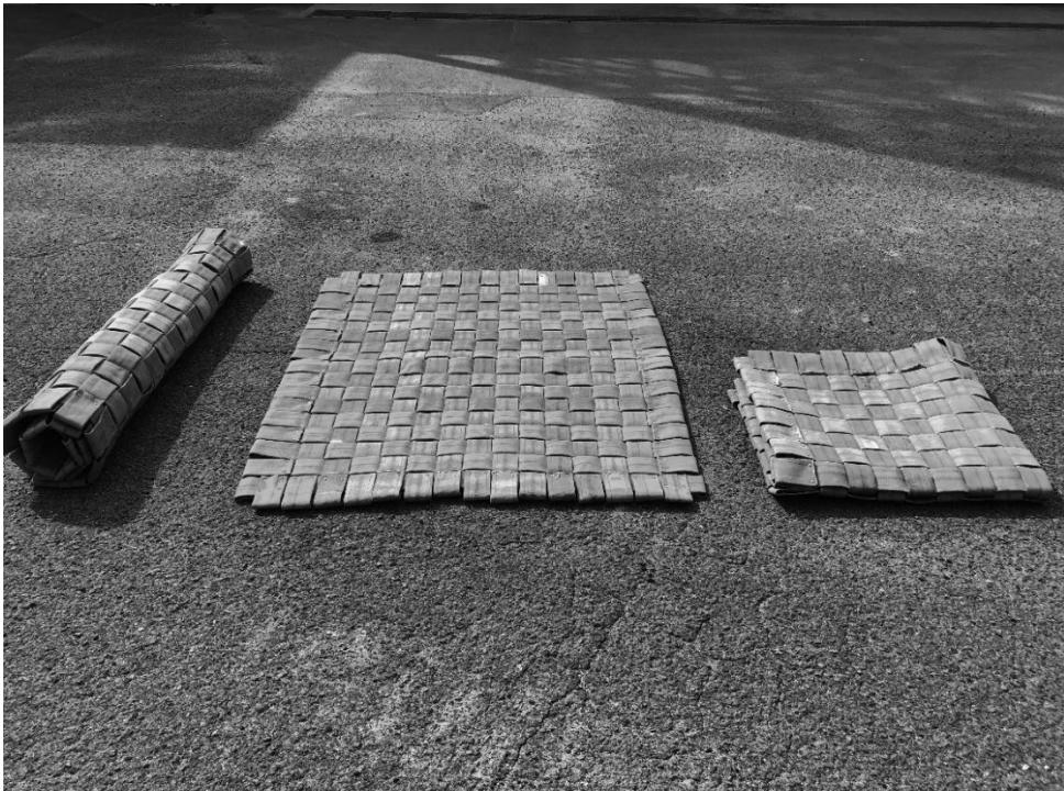
図8 左からロール（直径25 cm×長さ150 cm） 通常サイズ（180 cm×150 cm） 4つ折り（80 cm×70 cm×高さ20 cm）
