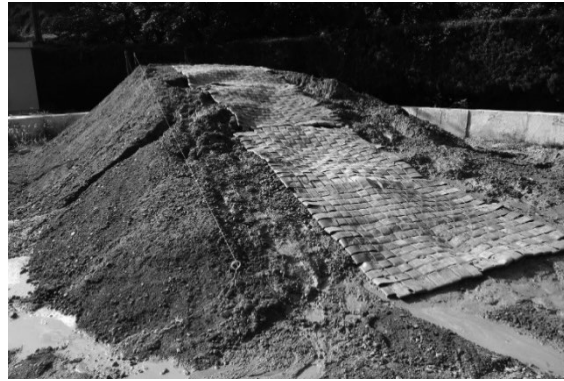
図6 ぬかるみ（傾斜地）（写真左）とマットの上を5人が歩行した後の様子（写真右）
