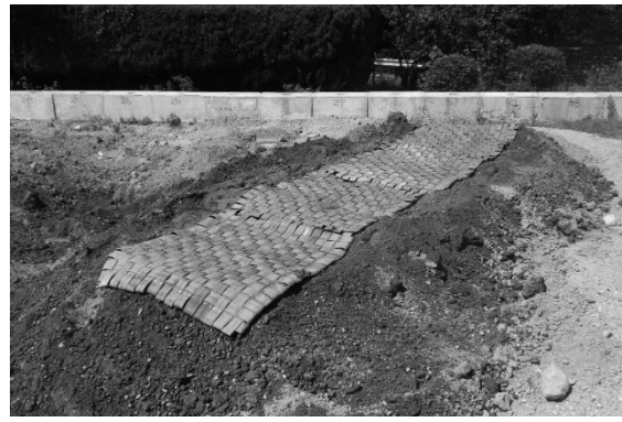
図5 ぬかるみ（平坦地）（写真左）と マットの上を5人が歩行した後の様子（写真右）
