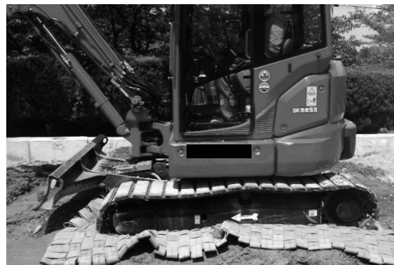
図7 ぬかるみに重機を停止させた様子（写真左）と マットの上に重機を停車させた様子（写真右）
