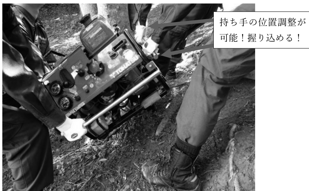
開発した可搬式ポンプ水平装置を山の斜面で搬送している様子
