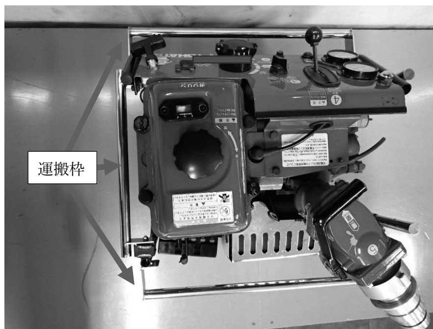
運搬枠を取り付けた可搬式ポンプを上方から撮影
