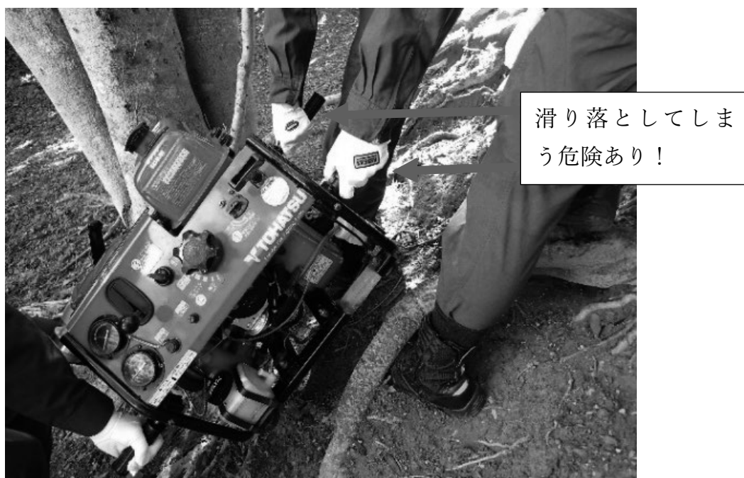
既存の可搬式ポンプを山の斜面で搬送している様子
