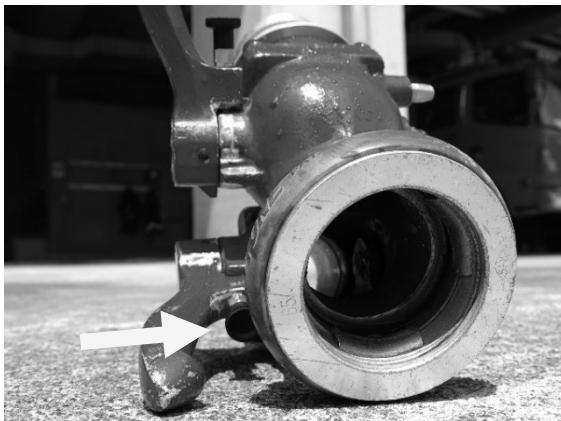
(インデックスプランジャが地面と接触しない状況② (全開時))
