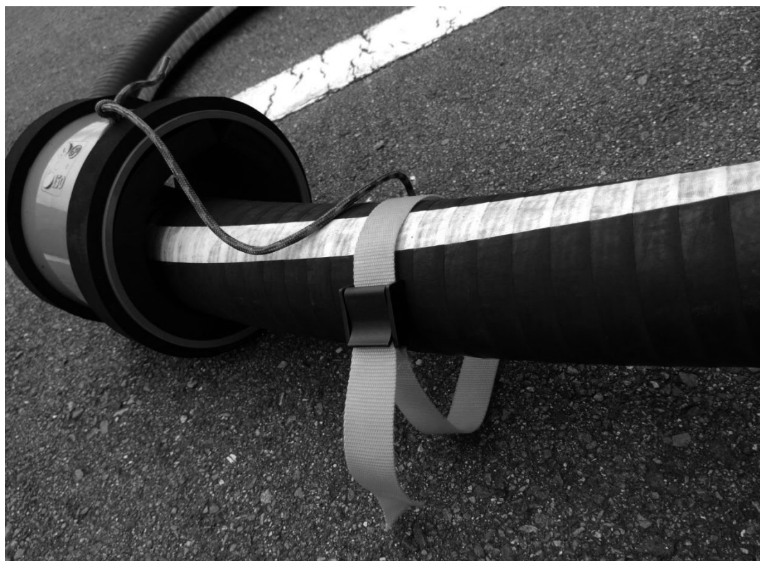
写真 10 固定バンドを緩めた状況（取付位置変更可能）
