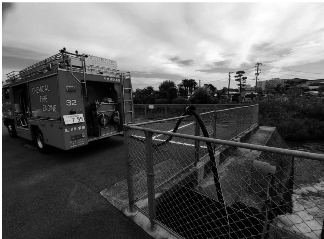
写真7 吸管備え付け型枕木使用状況
