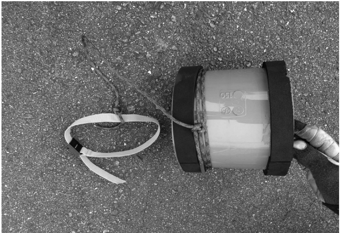
写真2 塩ビ管に固定バンドをロープで取付けた状況
