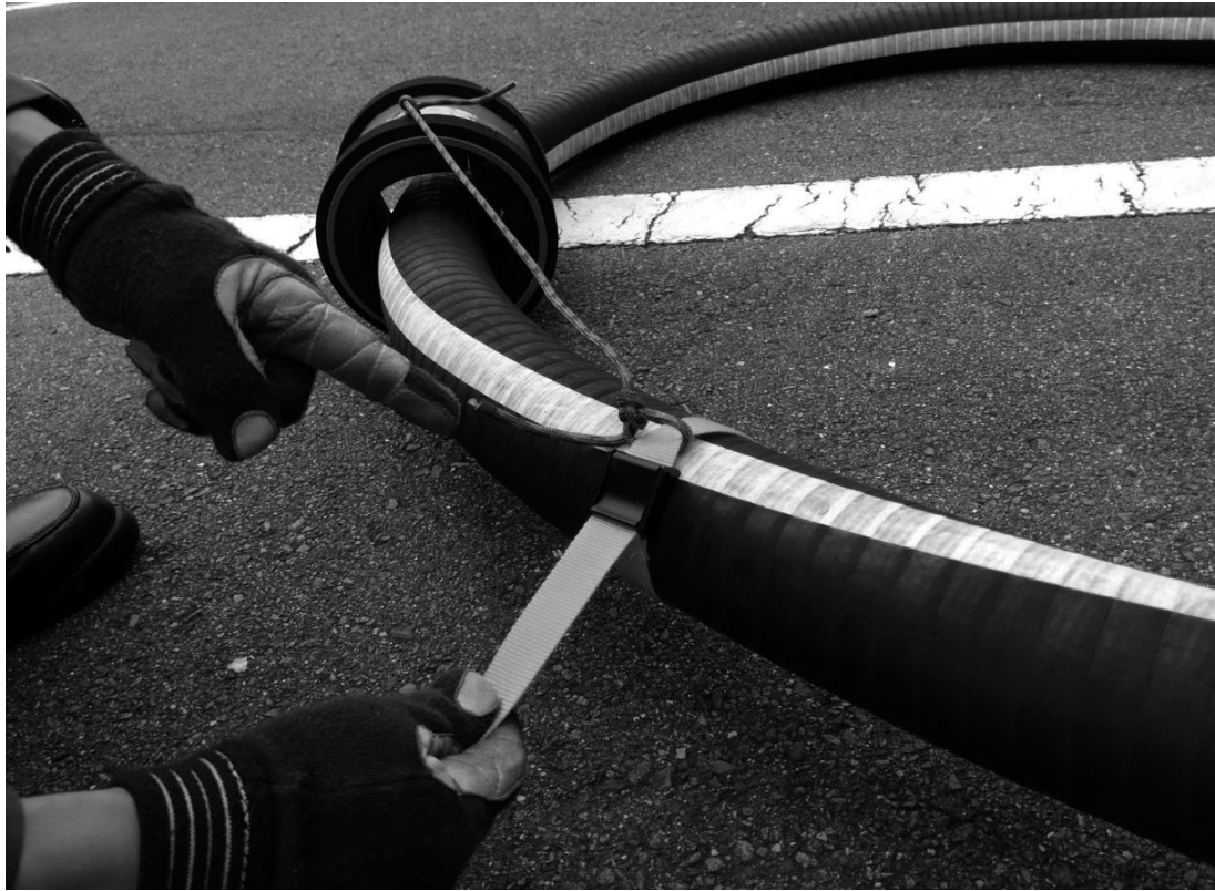
写真 1 1 紐（黄色）を引きロックすることで吸管に固定
