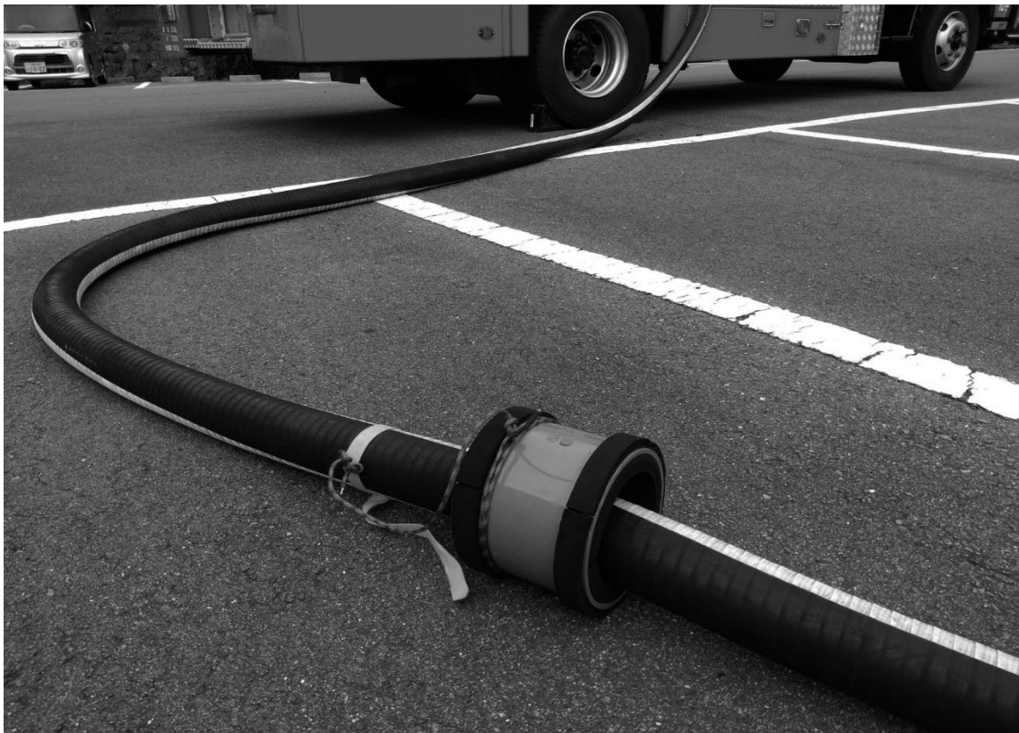
写真6 吸管延長時の状況
