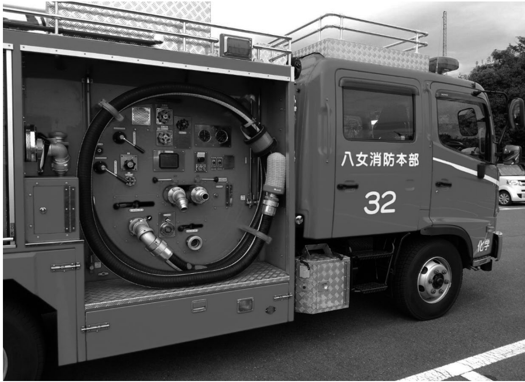
写真3 吸管備え付け型枕木設定状況
