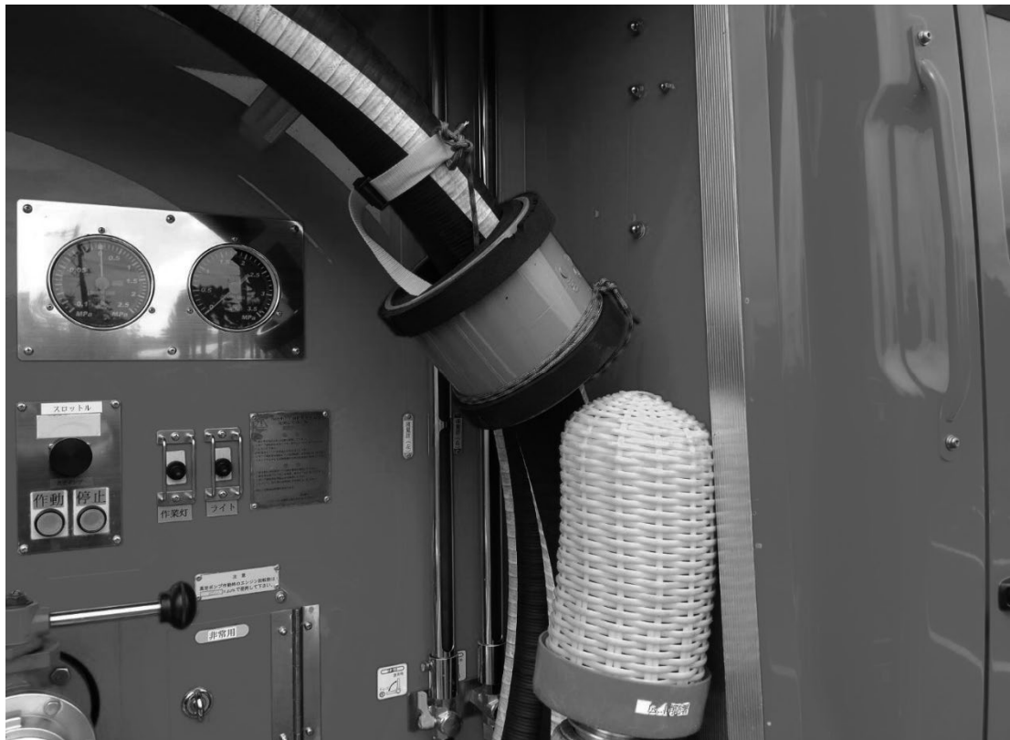
写真5 吸管備え付け型枕木設定状況（拡大）
