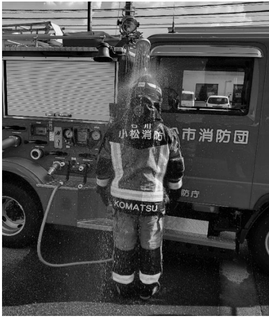
【写真16】シャワーヘッドにより一人での除染が可能
