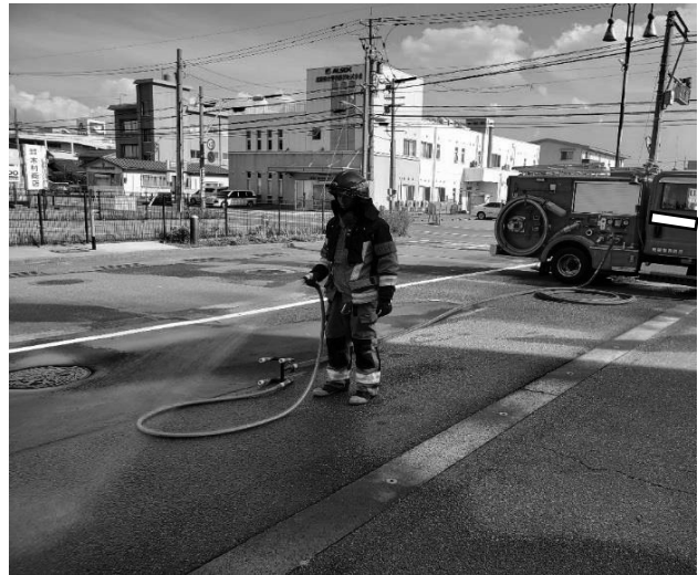
【写真17】消防用ホースと連結させて遠距離での活動が可能
