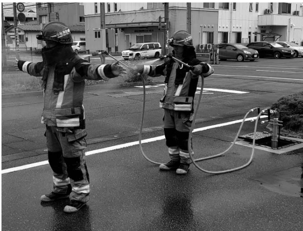
【写真18】消火栓へ直接取り付け使用可能
