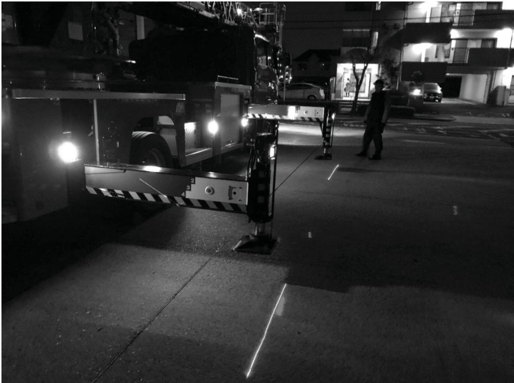
図2 アウトリガー完全張り出し状況
