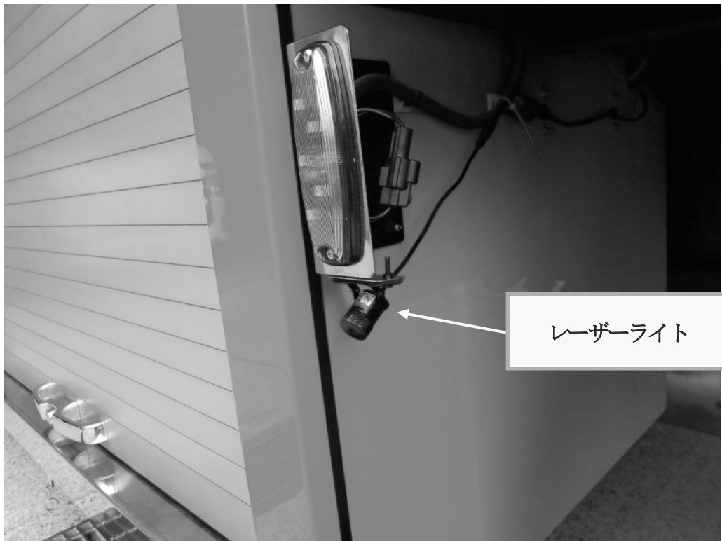
図3 レーザーライト設置状況（右前アウトリガー付近）
