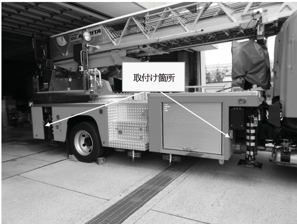
図4 レーザーライト取付け箇所（車両右側）
