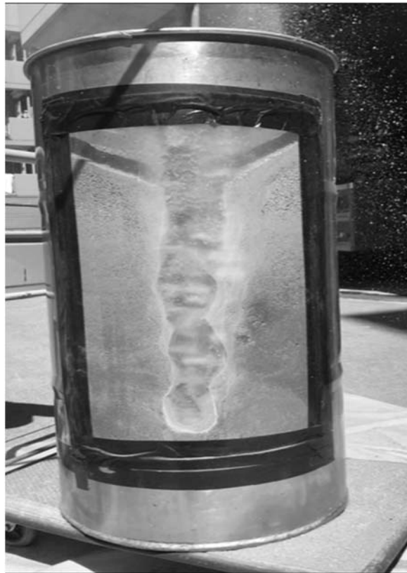
写真5 空気噴射管の風圧による海砂の空洞化
