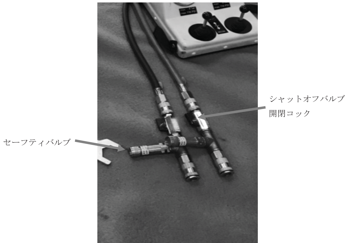
写真2 シャットオフバルブの状況
