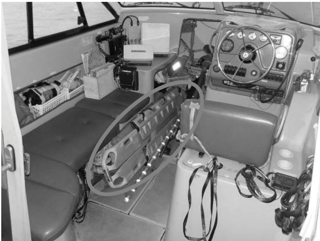
写真 1 2 消防艇におけるフロートスクープ積載状況
