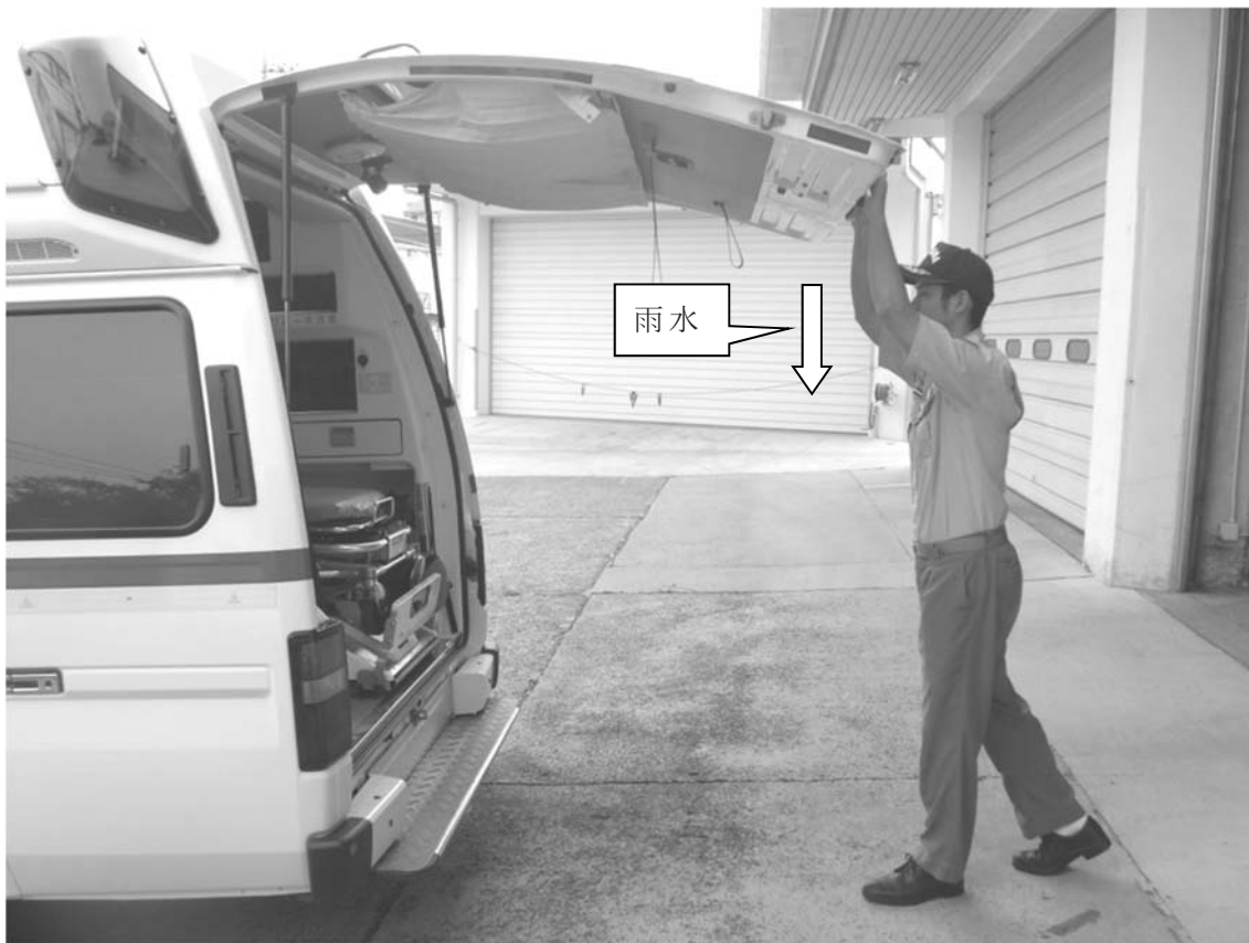
現状、バックドア閉鎖時に、ドア上の雨水がかかる状況
