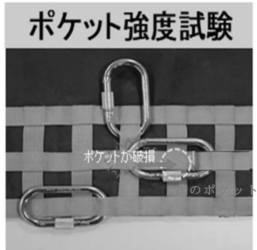
【写真8】ポケット部分の縫製が破損しても次の縫製部分が支える構造。
