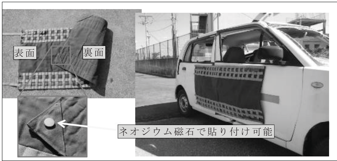
【写真6】ネオジウム磁石の使用例
