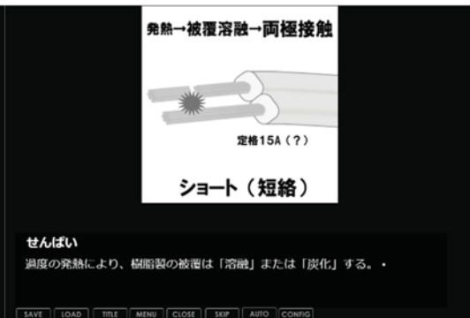
写真 32 各種説明（半断線によるショート）
