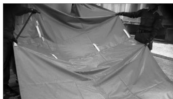
※結果：水漏れ、破損なし
