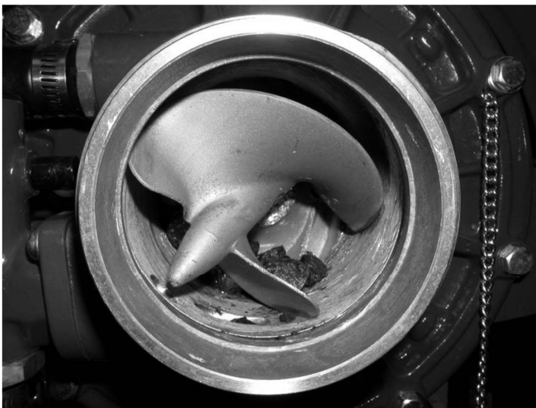
【写真6 異物によりポンプ内部が破損した可搬消防ポンプ1】
