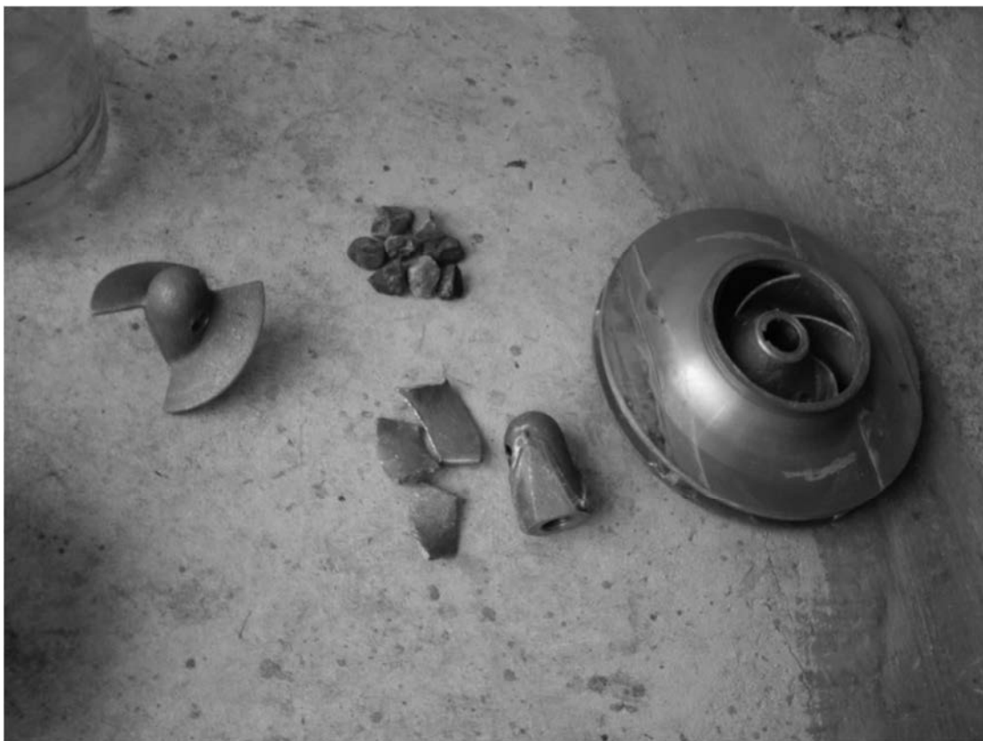
【写真7 異物によりポンプ内部が破損した可搬消防ポンプ2】
