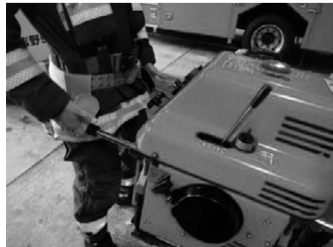
補助具を利用し可搬ポンプを搬送
