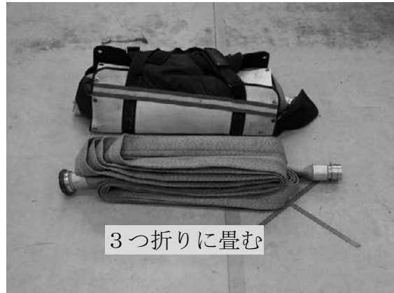
写真2 「狭所コイル巻き」完成
