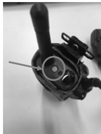
写真⑥緊急通知スイッチ (エマージェンシー機能作動スイッチ)
