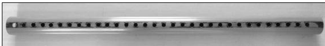
直径12mmの穴を30mm間隔であけ、テープで蓋をする
