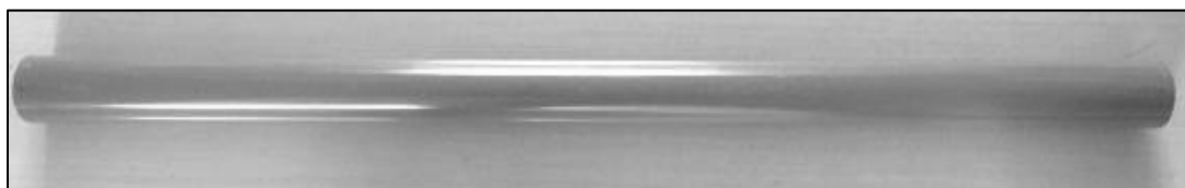
塩ビ管 (長さ1,000mm、直径60mm、厚さ2mm)
