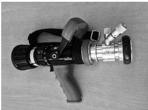
写真 9 放水器具（ガンタイプノズル）への取付状況
