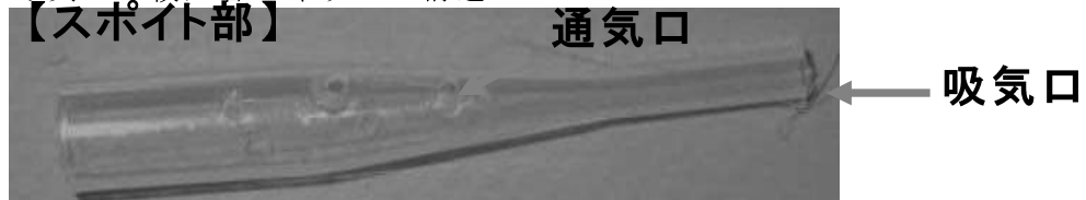
写真8 検知管キャップの構造
