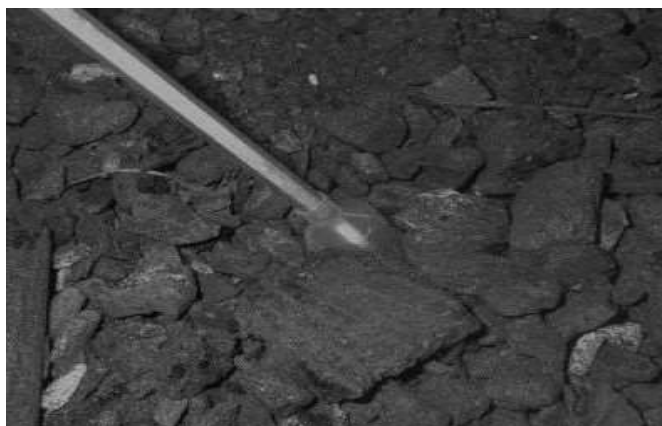
写真 9 検知管キャップの残さ物検知
