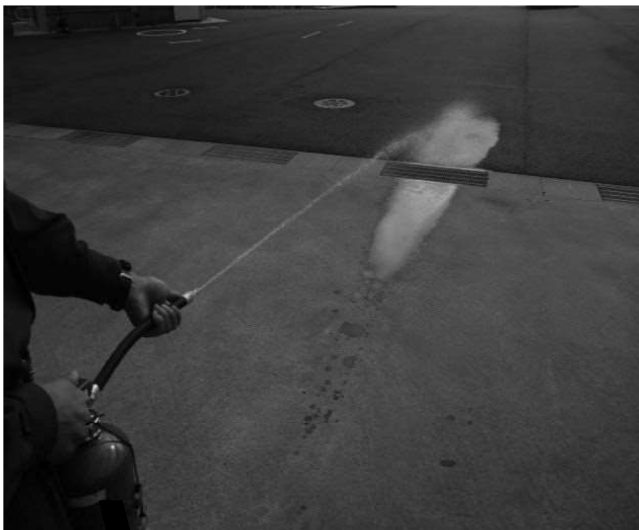
写真1 訓練用水消火器（改良前）放射
