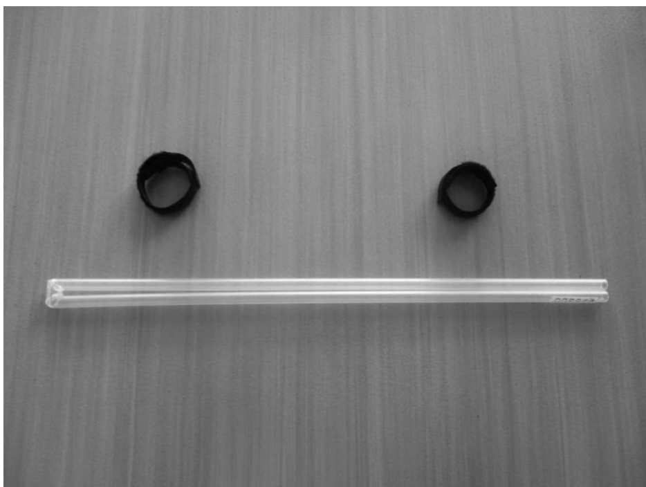
写真2 コの字型に加工したパイプ及び固定バンド
