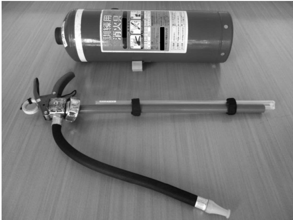
写真3 サイホン管にパイプを差し込みバンドで固定
