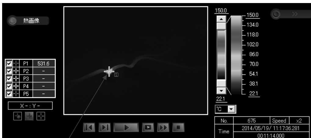
写真 1 3 発火直前の温度状況（熱画像装置画像）
