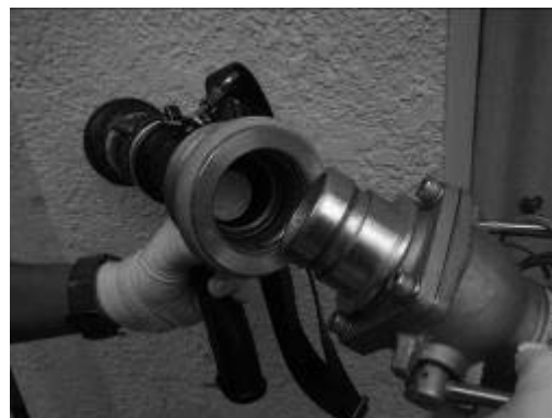
【写真 10】 A B 管そう内への カートリッジ装填状況②
