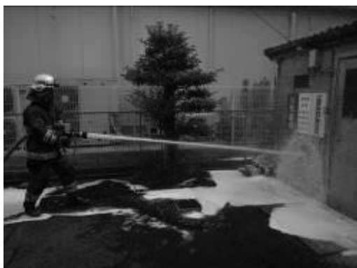
【写真 11】 カートリッジ式泡水溶液 放水システムによる放水状況
