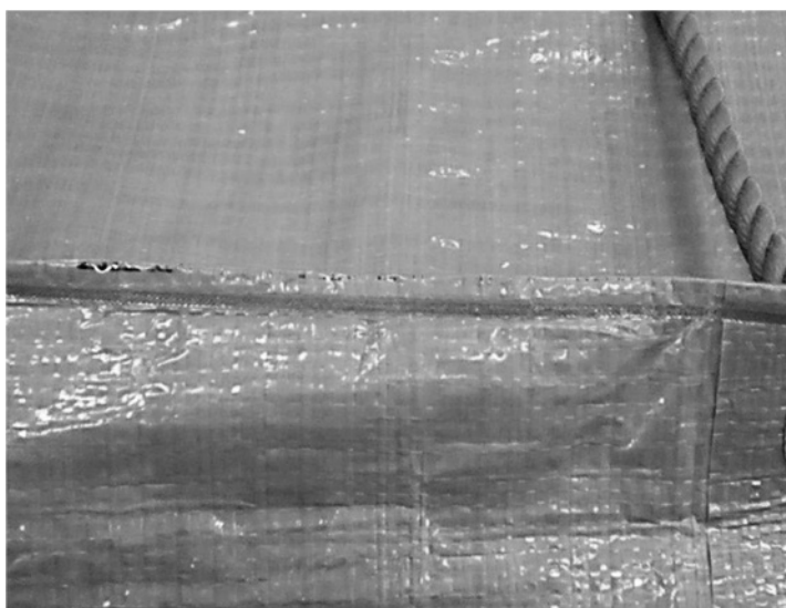
写真No. 4 折り目をヒートシーラーで熱圧着した状態
