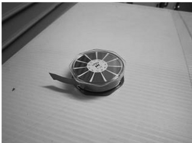
写真1 現行のpH試験紙
