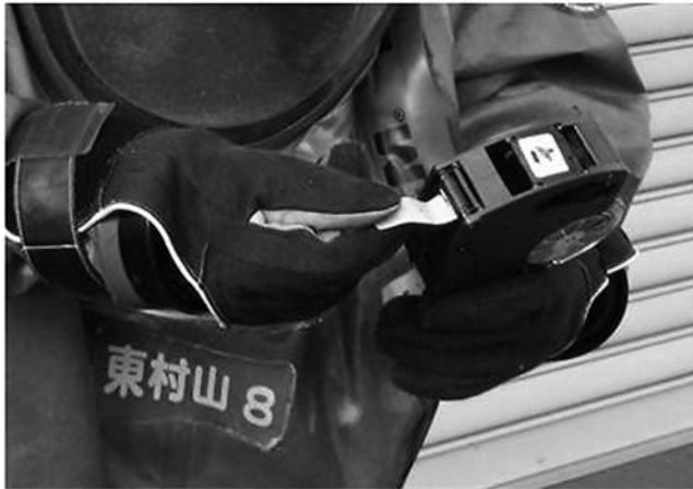
写真 1 1 改良型 pH 試験紙を使用したときの改善状況
