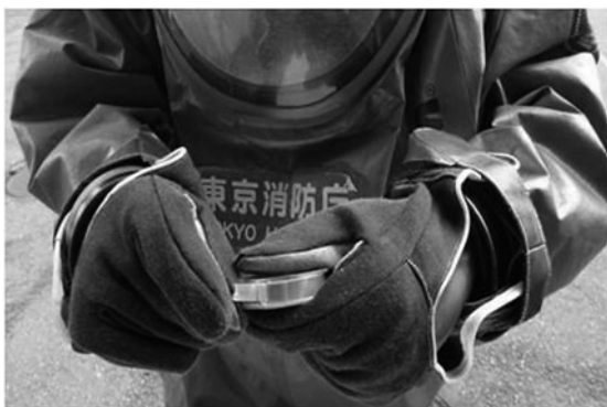
写真 6、7 現行の pH 試験紙における使用失敗例
