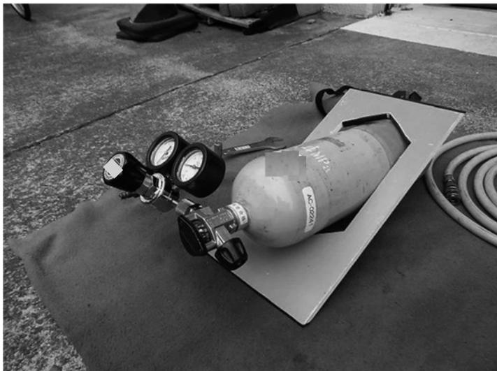
調整器取り付け前にそく止弁側から本体に被せる。ボンベは自重でしっかりと固定され、調整器及びそく止弁も空中に浮き、保護されている。
