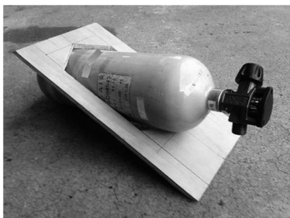
概ね良好であったが、傾斜地などでは若干の不安が残ったので、接地面にゴムを貼ることにより対応した。ダストキャップ紛失防止の為、本体横にダストキャップホルダーを設置した。（写真下）
