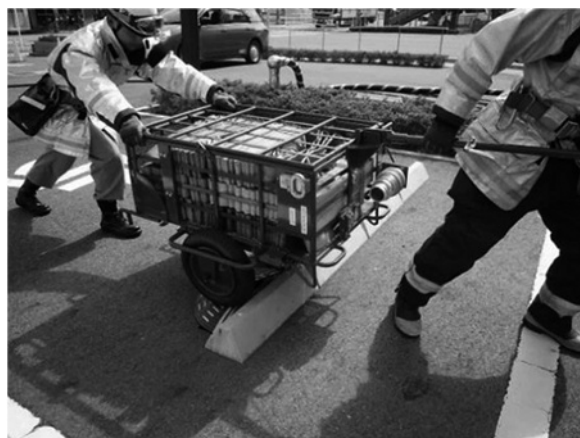
写真 1 0 「段差をクリアする資機材」
