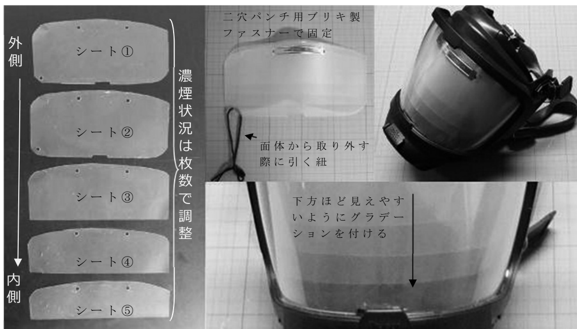
写真1 空気呼吸器面体用濃煙疑似シート
