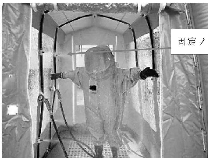
写真No.8 固定ノズルから中性洗剤水の洗浄
