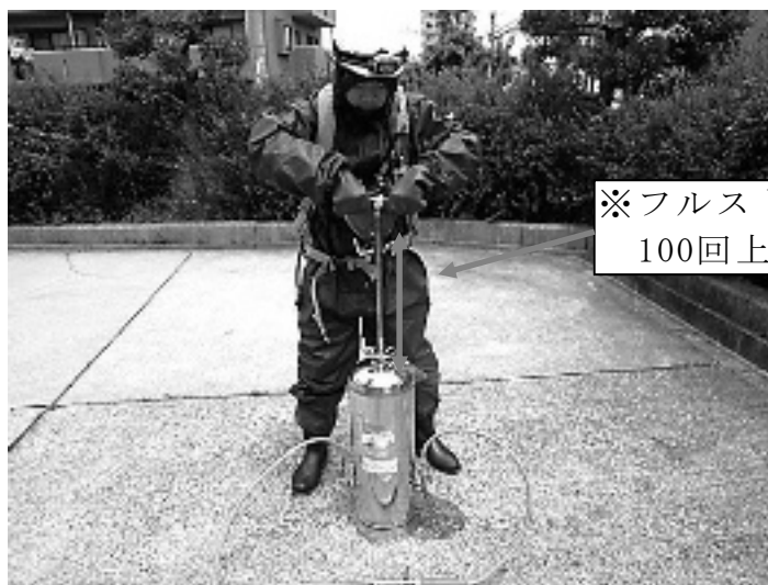
写真No.5 人力による中和剤散布機の加圧作業
