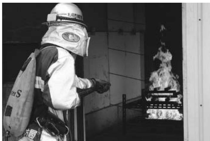
時間計測は実験物体への着火から計測を開始し消火され残火も概ね終了したと見なされる時間までとした。
