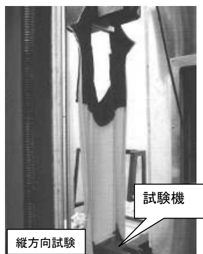
写真8 引張強伸度試験（破損時）
