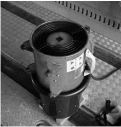
(写真3) 送排風機を立てて活用 する方法を考案(1号機)
