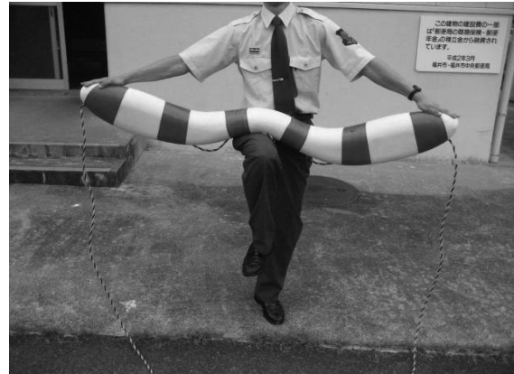
救命浮環開脚時 (180度以上開脚しても折れず、手を離すと、すぐに元の形状に戻る)
