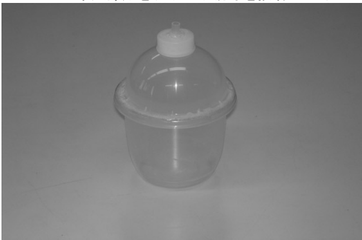
油分を含んだ焼き残存物を収容する専用容器 蓋の中央部分を切り取り漏斗を接着したもの
