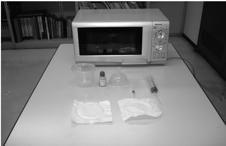
油分を含んだ焼き残存物を収容する専用容器 蓋の中央部分を切り取り漏斗を接着したもの
