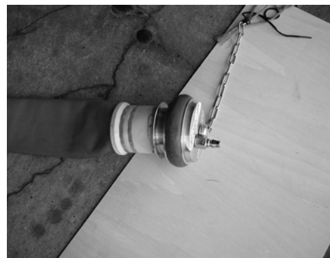
写真⑥ ホースのオス金具に接続
